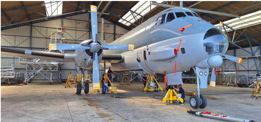
Tripodes réalisés pour le soutien au sol de l'ATL2 (Atlantique 2) de la Marine nationale
